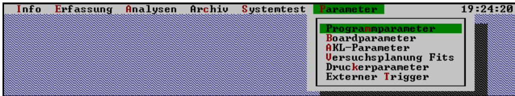
Abbildung 1. Grundmenü von HAND mit aktivem Scrollbar „Parameter“ zur nutzerspezifischen Anpassung des Systems.
